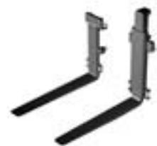
Gabel mit hydraulischer Schrägstellung
